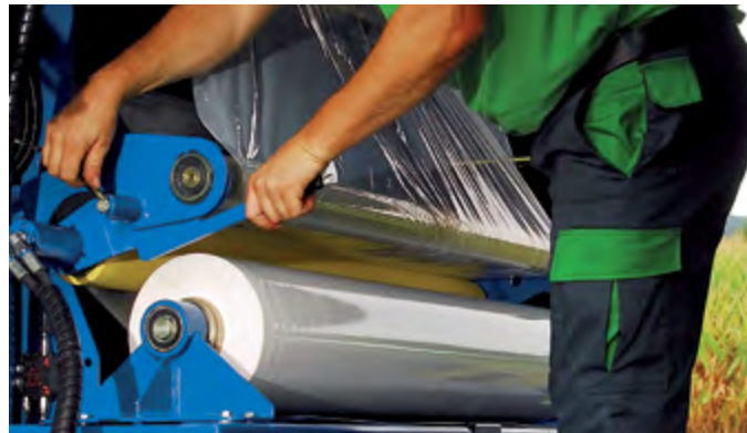
Folienbindung kombiniert mit Netzbindung
