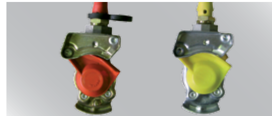
Bremsanschluss für die Zweileitungs-Druckluftbremsanlage
