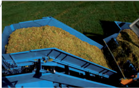
Perfekt dosiert gelangt das Material vom Zubringer zum Steilförderer
