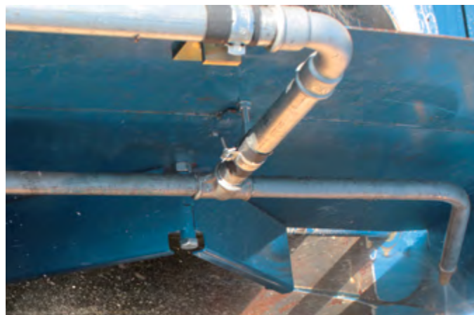
Wassereinspritzung für Presskammer
