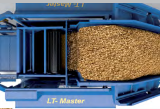
Vom Steilförderer fällt das Material in die Presskammer
