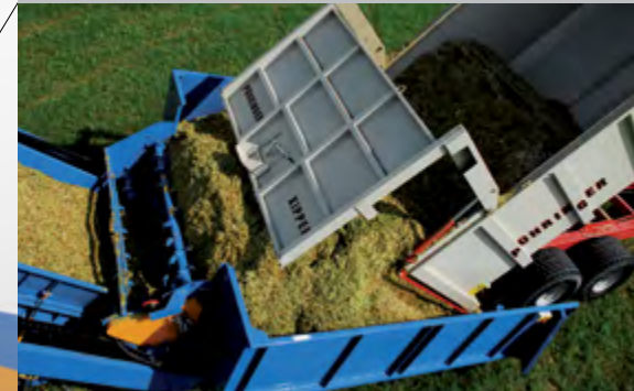
Das Material wird in den geräumigen Zubringer abgeladen
